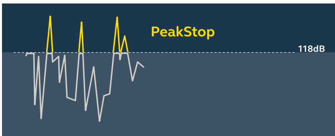
그림 2: PeakStop은 사운드 플로우를 지속적으로 모니터링하고 적극적으로 유해한 사운드 피크를 안전한 수준으로 줄입니다.
